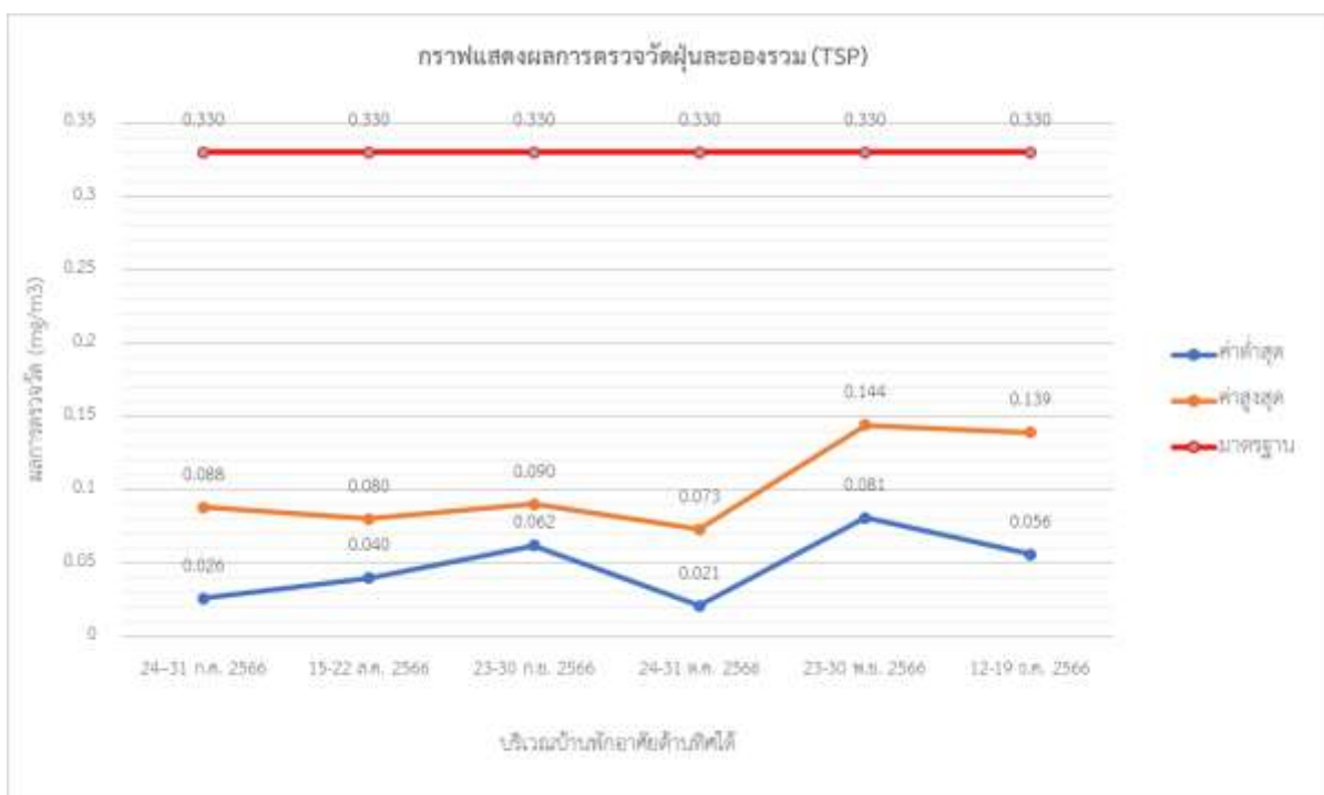
รูปที่ 3.2-8 กราฟแสดงผลการตรวจวัดฝุ่นละอองรวม (TSP) ในบรรยากาศ (ต่อ)
