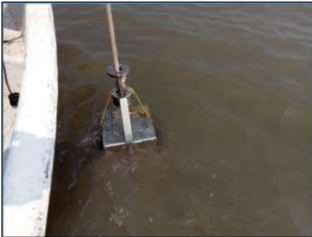
รูปที่ 3.1-22 การเก็บตัวอย่างคุณภาพตะกอนดิน บริเวณแม่น้ำบางปะกง ก่อนจุดบรรจบคลองแสมไข่ (SD5)
