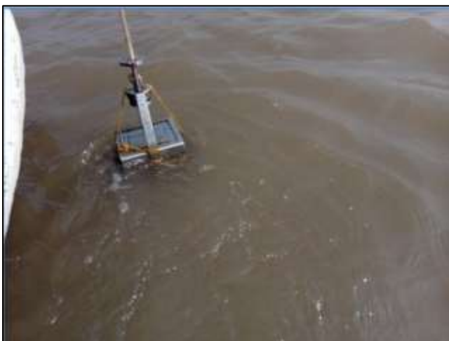
รูปที่ 3.1-23 การเก็บตัวอย่างคุณภาพตะกอนดิน บริเวณแม่น้ำบางปะกง หลังจุดบรรจบคลองแสมไข่ (SD6)
