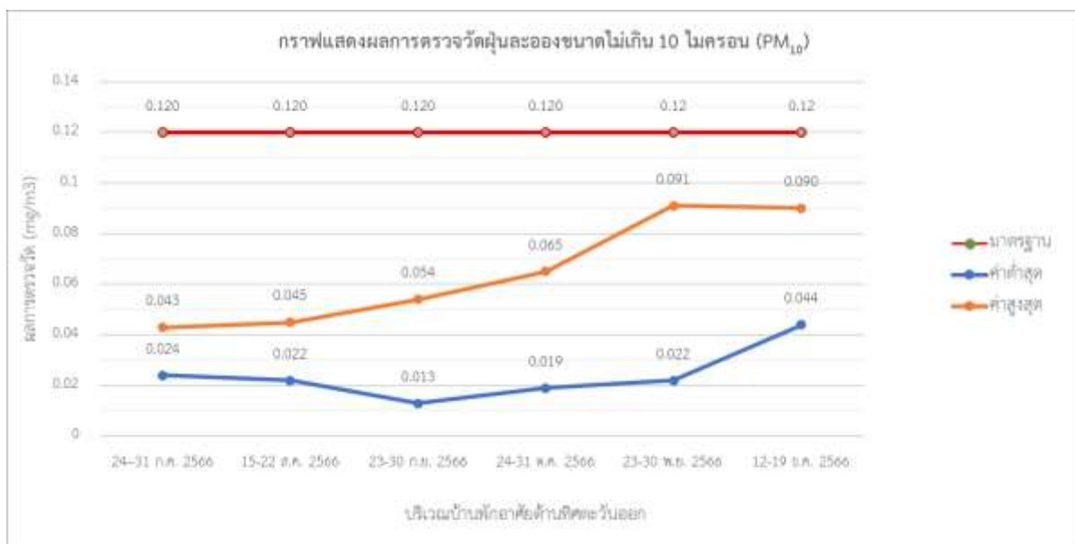
รูปที่ 3.2-9 กราฟแสดงผลการตรวจวัดฝุ่นละอองขนาดไม่เกิน 10 ไมครอน ( PM_{10} ) ในบรรยากาศ
