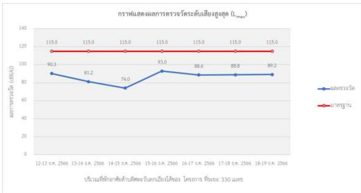
รูปที่ 3.2-18 กราฟแสดงผลการตรวจวัดระดับเสียงสูงสุด ( L_{max} )
