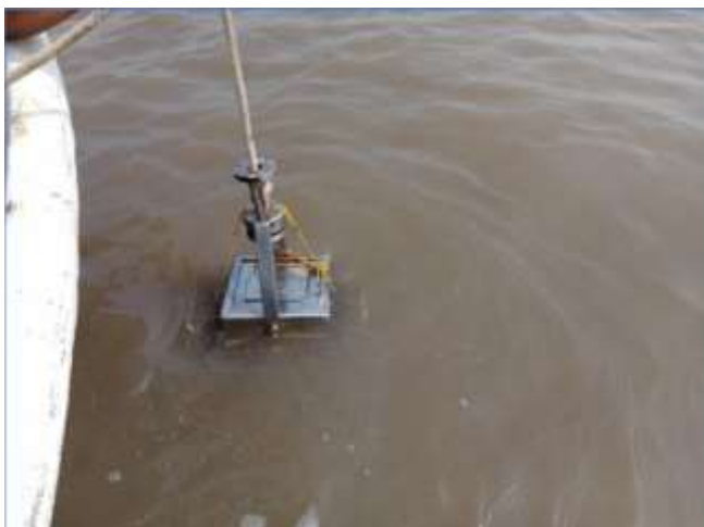
รูปที่ 3.1-20 การเก็บตัวอย่างคุณภาพตะกอนดิน บริเวณคลองแสมไช้ หลังจู่ระบายน้ำทิ้งของโครงการ (SD3)
