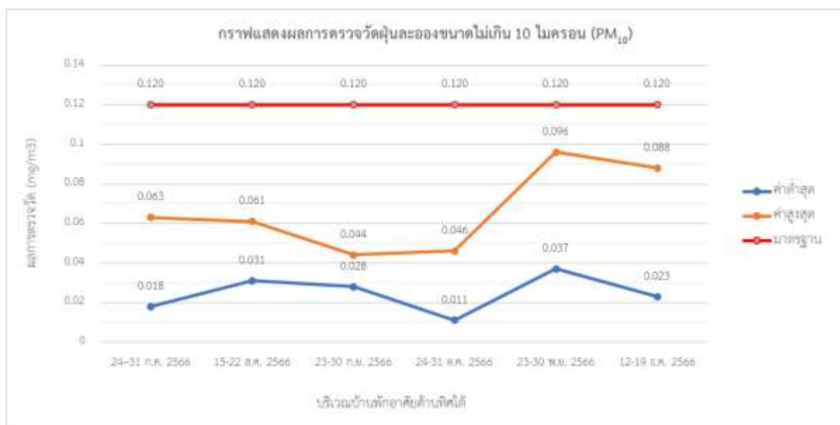
รูปที่ 3.2-9 กราฟแสดงผลการตรวจวัดฝุ่นละอองขนาดไม่เกิน 10 ไมครอน (PM 10 ) ในบรรยากาศ (ต่อ)
