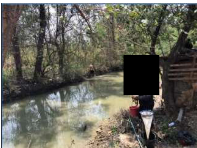
รูปที่ 3.1-26 การเก็บตัวอย่างคุณภาพตะกอนดิน บริเวณคลองยายอยู่ (SD9)
